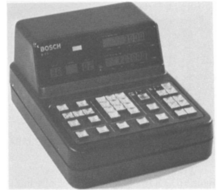
Figure G-1. Bosch-Fernseh BFS9 single frame display unit.
