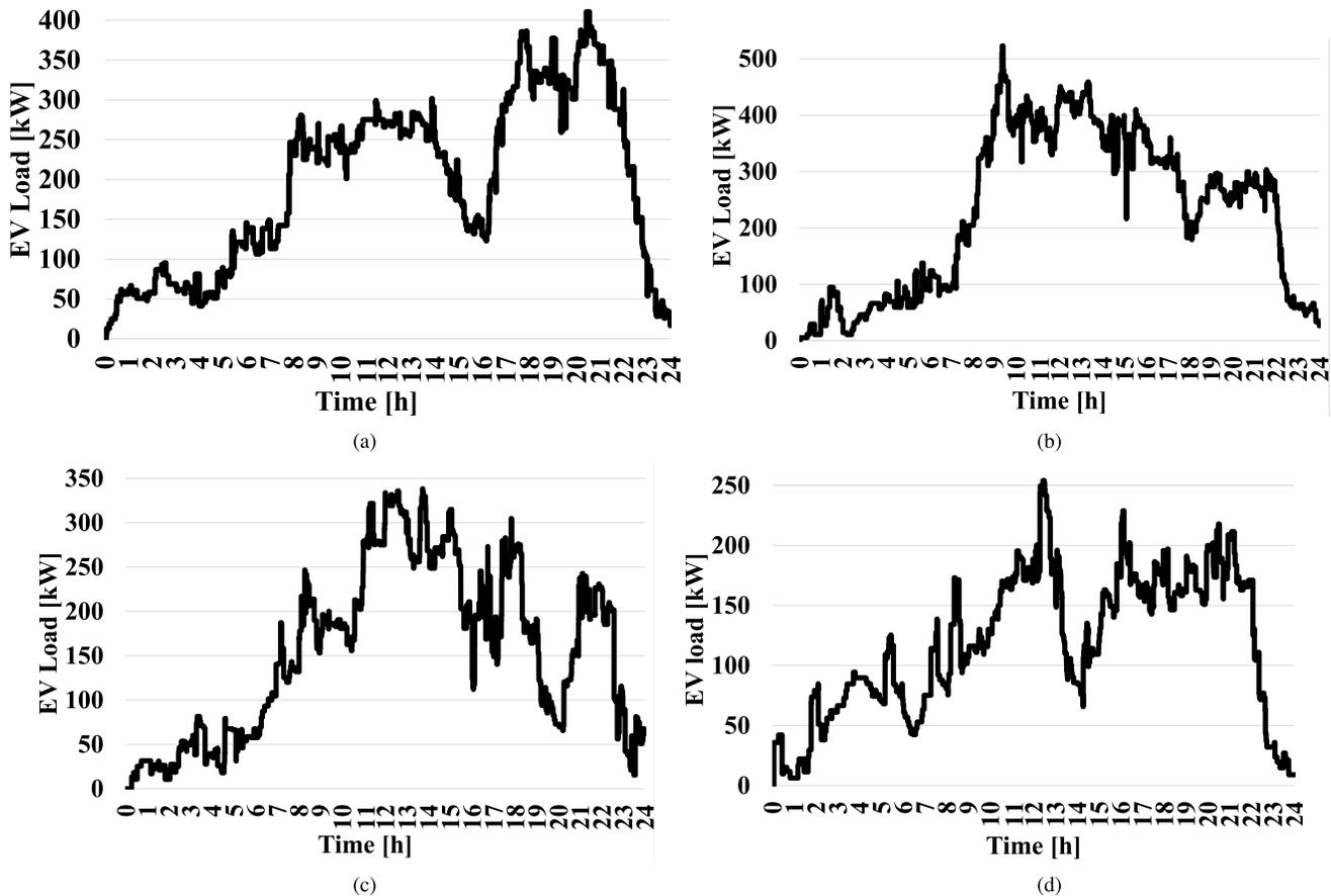
Fig. 10. Total EVs load demand (aggregator load profile). (a) CS1. (b) CS2. (c) CS3. (d) CS4.
