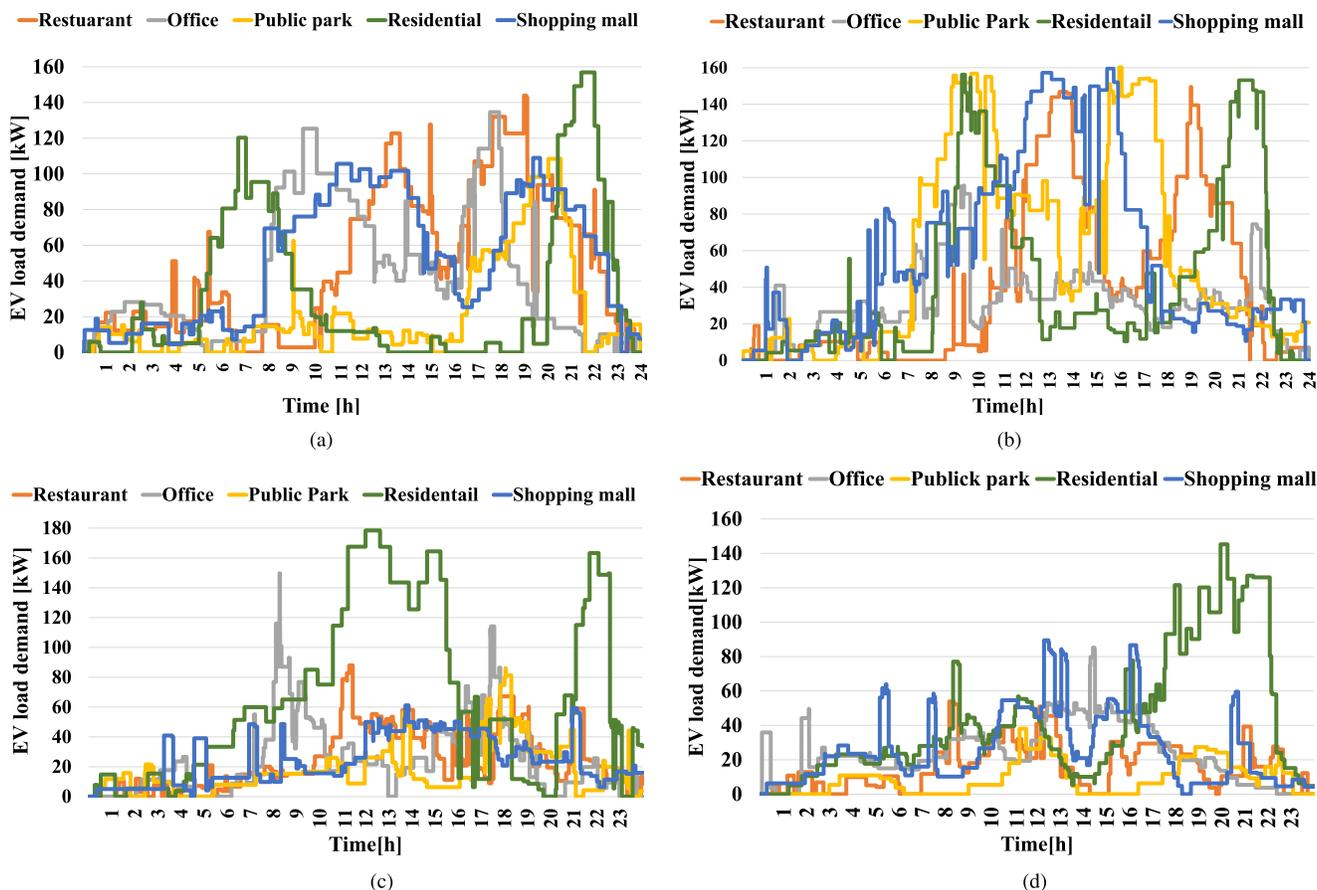
Fig. 11. Individual EV load profile (CS/PL operator load profile). (a) CS1. (b) CS2. (c) CS3. (d) CS4.
